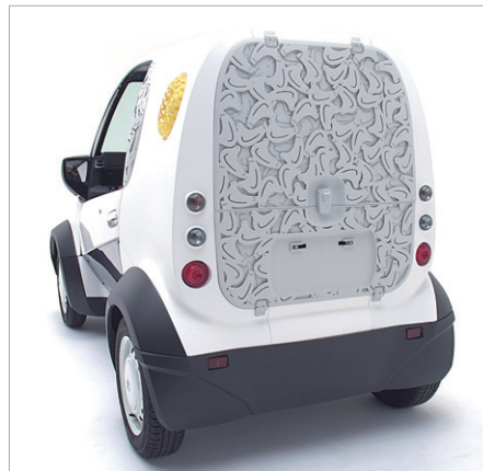
愛らしい鳩が重なり合ったバックドアの造形は、3D プリンターでしか実現できない重層的なデザイン。
