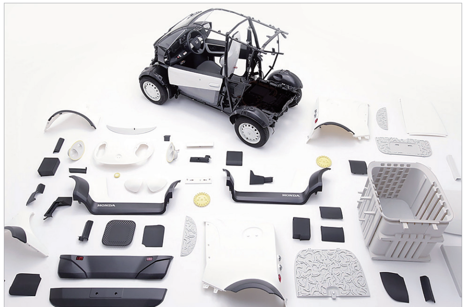
超小型 EV の骨格 (写真上) 以外、ほぼすべての外装を 3D プリンターによって製造。素材にはハイグレードの ABS 樹脂を採用した。
